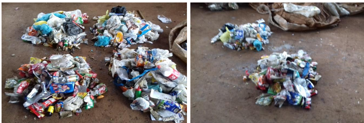
Figura 18. Quarteamento e Descarte de dois dos quartis. Fonte: LL Ambiental
