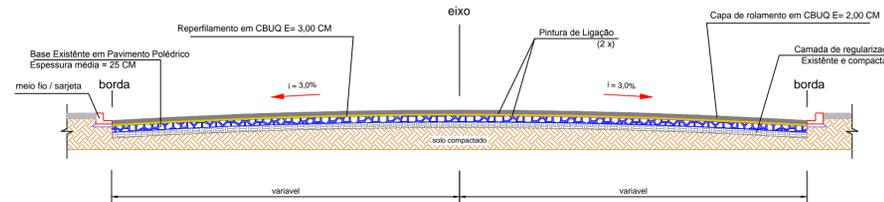
Seção Transversal (Corte AA) dos Trechos de Recape Sobre Pedra Irregular
