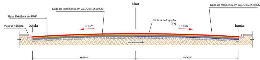
Seção Transversal (Corte AA) - Trecho de Recape sobre Pavimento em PMF
