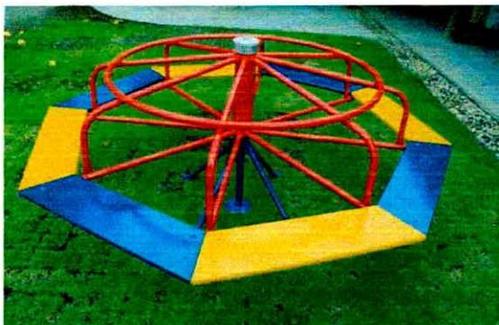
Carrossel de ferro carrossel infantil com estrutura e arco com tubo/metal galvanizado de 1/2" com 1,90 metros de diâmetro, eixo trefilado, com 2 rolamentos e tripé em ferro galvanizado de 1/2. 8 (oito) tábuas com 72cm de comprimento x 19cm de largura e 2cm de espessura em itaúba aproximadamente.
