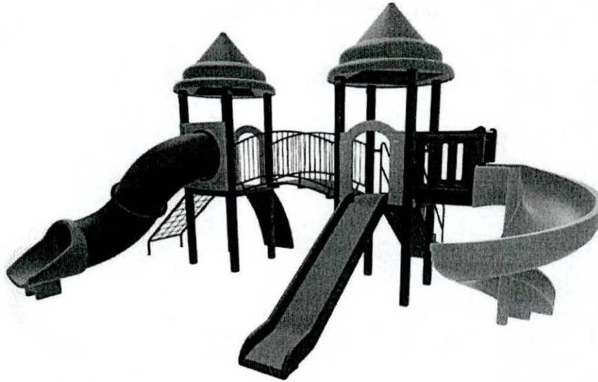
**Conjunto de Parque infantil colorido** com estrutura principal de colunas em alumínio com mínimo de 11cmx11cm e cantos ovalizados, de no mínimo 3 metros de comprimento, espessura das chapas mínimo de 3mm, parede dupla com mínimo de 3 reforços internos e pintura com tinta a pó de poliéster marrom, contendo no mínimo:
