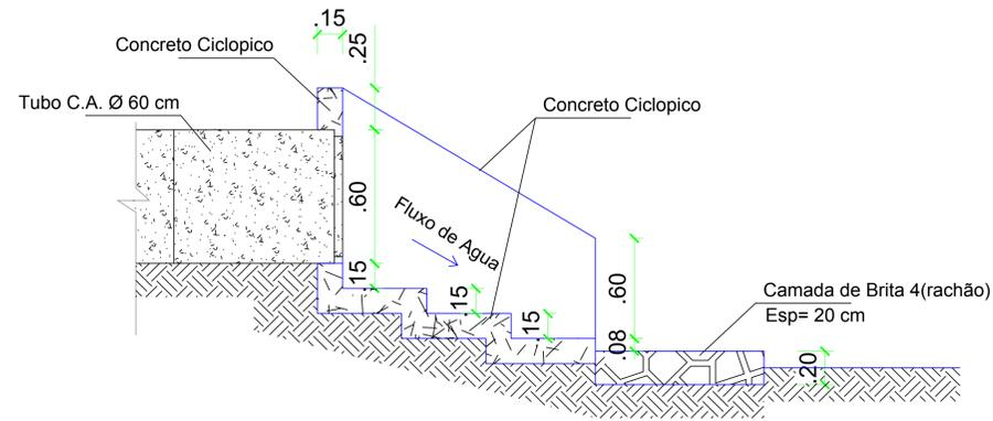
SEÇÃO TRANSVERSAL DO DISSIPADOR
