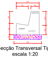
Detalhe do Meio-Fio com Sarjeta (DER Tipo 2 - 0.042 m 2 /m) (medidas em centímetros)
